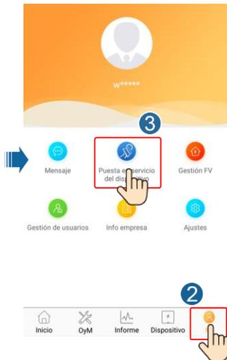
2. Conéctese a la red WLAN del inversor solar e inicie sesión como **installer** para acceder a la pantalla de puesta en servicio del dispositivo.
